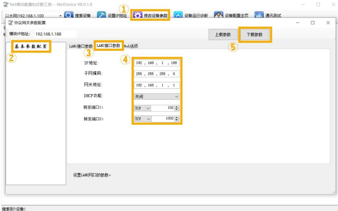
IP地址、子网掩码、网关地址分别为 QSK LAN-NAT 的 LAN2 接口的 ip 地址、子网掩码、网关。LAN2 接口的 IP 地址与连接的 PLC 的 IP 地址不一定要在同一网段（IP 地址可设置为其他网段）。
