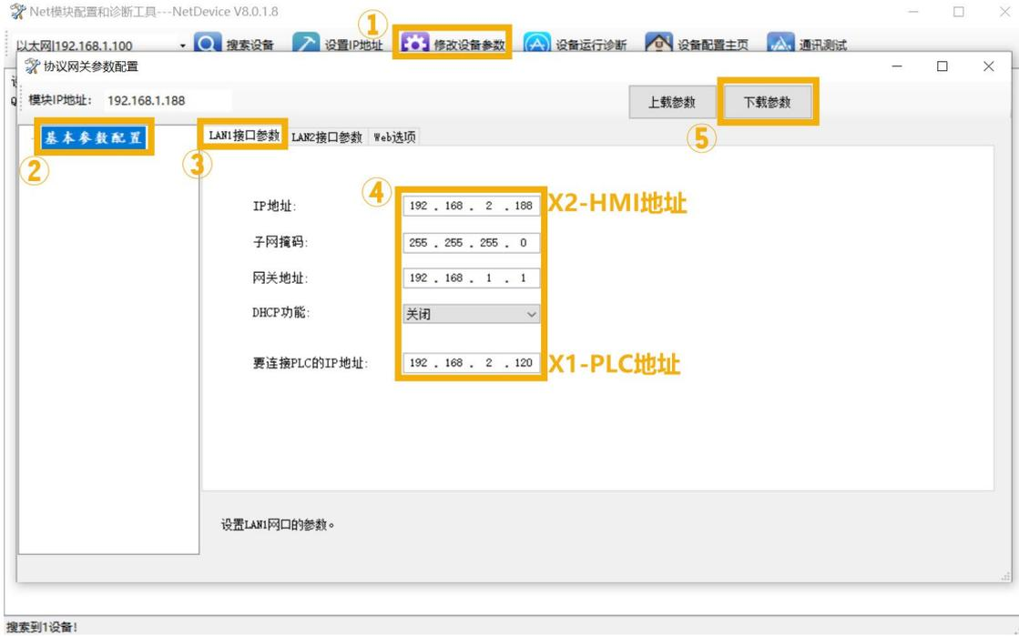
IP地址、子网掩码、网关地址分别为 QSK LAN-NAT 的 LAN1 接口的 ip 地址、子网掩码、网关。
