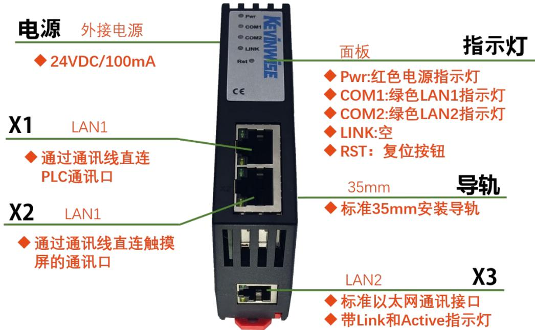
QSK LAN-NAT 具备两路物理性接口，LAN1 和 LAN2 口分别具备独立的局域网功能。其中 LAN1 口为一个双 RJ45 接口，具备交换机功能，主要用于 PLC、数控等以太网设备的连接；LAN2 口为单端口 RJ45，主要用于上位机的连接；
