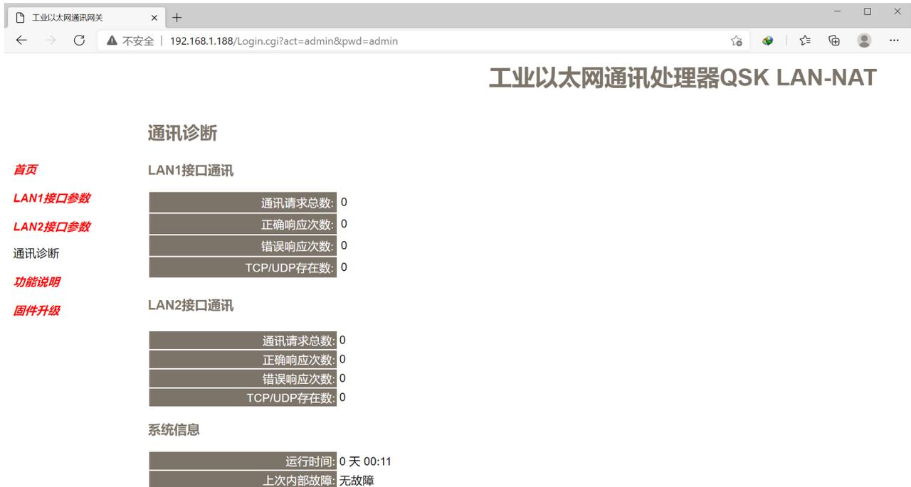
**LAN1 接口通讯**——>**通讯请求总数**：所有发送到 PLC 的通讯请求数目；
