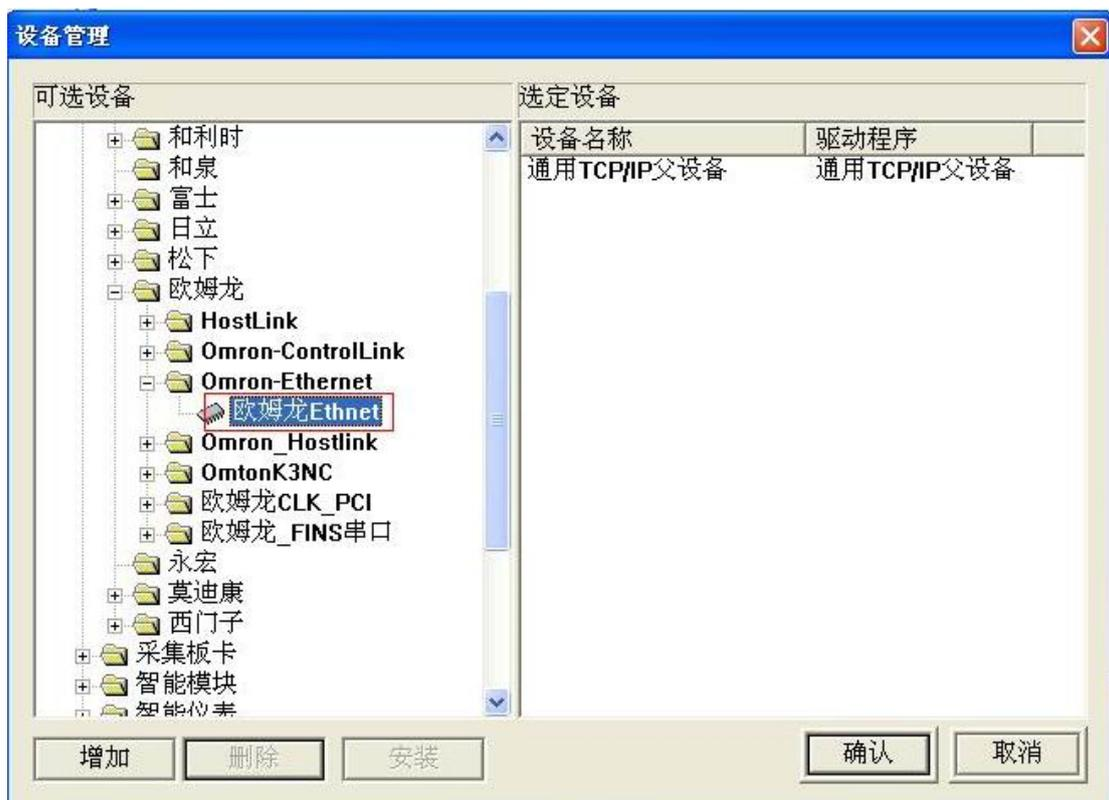
2. 双击“通用 TCP/IP 父设备 0-【通用 TCP/IP 父设备】”，选择正确的“网络类型”为“0-UDP”，在“本地 IP 地址”填入监控计算机的真实 IP 地址，在“远程 IP 地址”填入 QSK NET-CP 模块的 IP 地址，“远程端口号”填入 9600，其他参数默认即可，点击“确认”。
