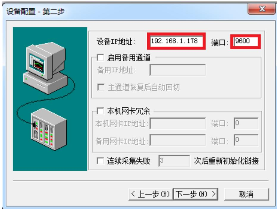
4. “型号类型”选择“CS/CP”，“本机节点”为监控 PC 的 IP 地址的最后一个数，例如 PC 的 IP 地址为 192.168.1.10，本机节点就是 10，“目标节点”为 QSK NET-CP 的 IP 地址的最后一个数，例如 QSK NET-CP 的 IP 地址为 192.168.1.178，目标节点就是 178，点击完成。
