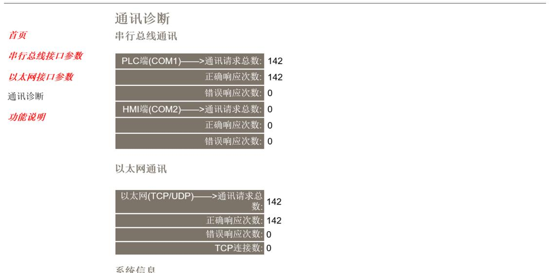
COM1—通讯请求总数：所有发送到 PLC 的通讯请求数目；
