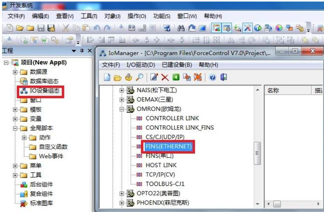
2.新建一个设备，输入“设备名称”，通信方式选为“TCP/IP 网络”点击“下一步”。
