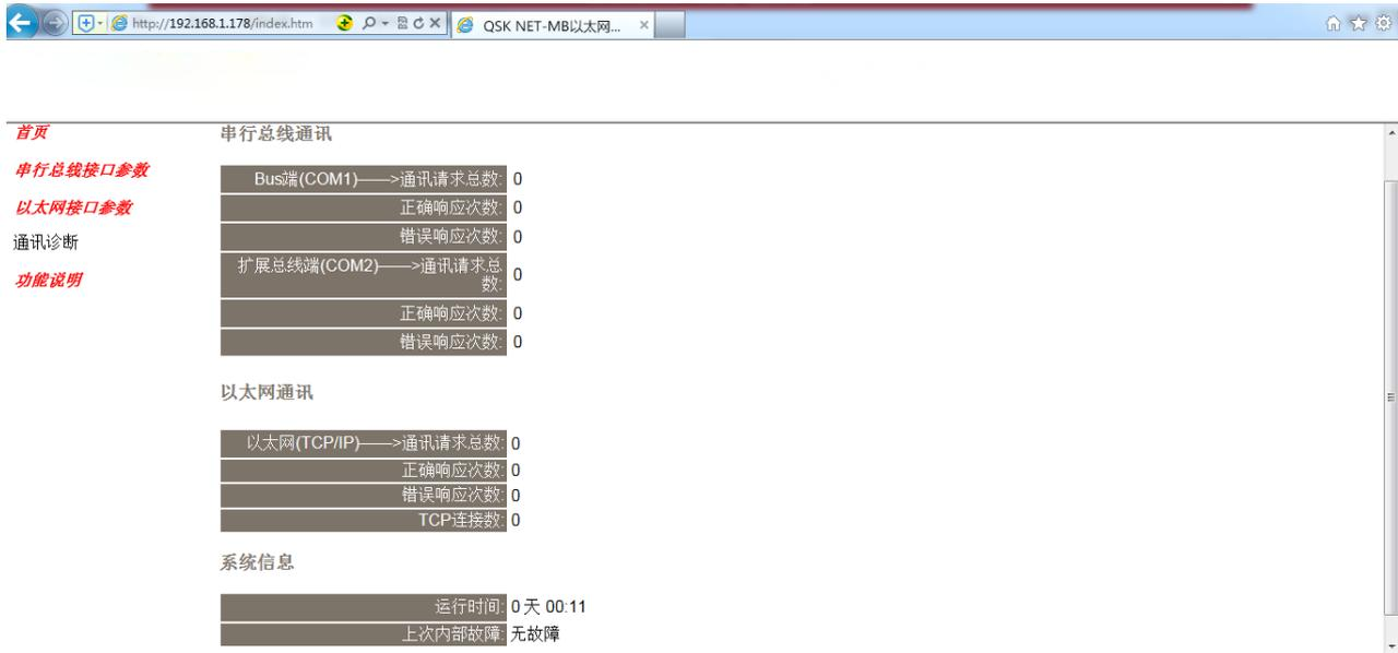
**Bus 端（COM1）—通讯请求总数：**所有发送到 Modbus 设备的通讯请求数目；
