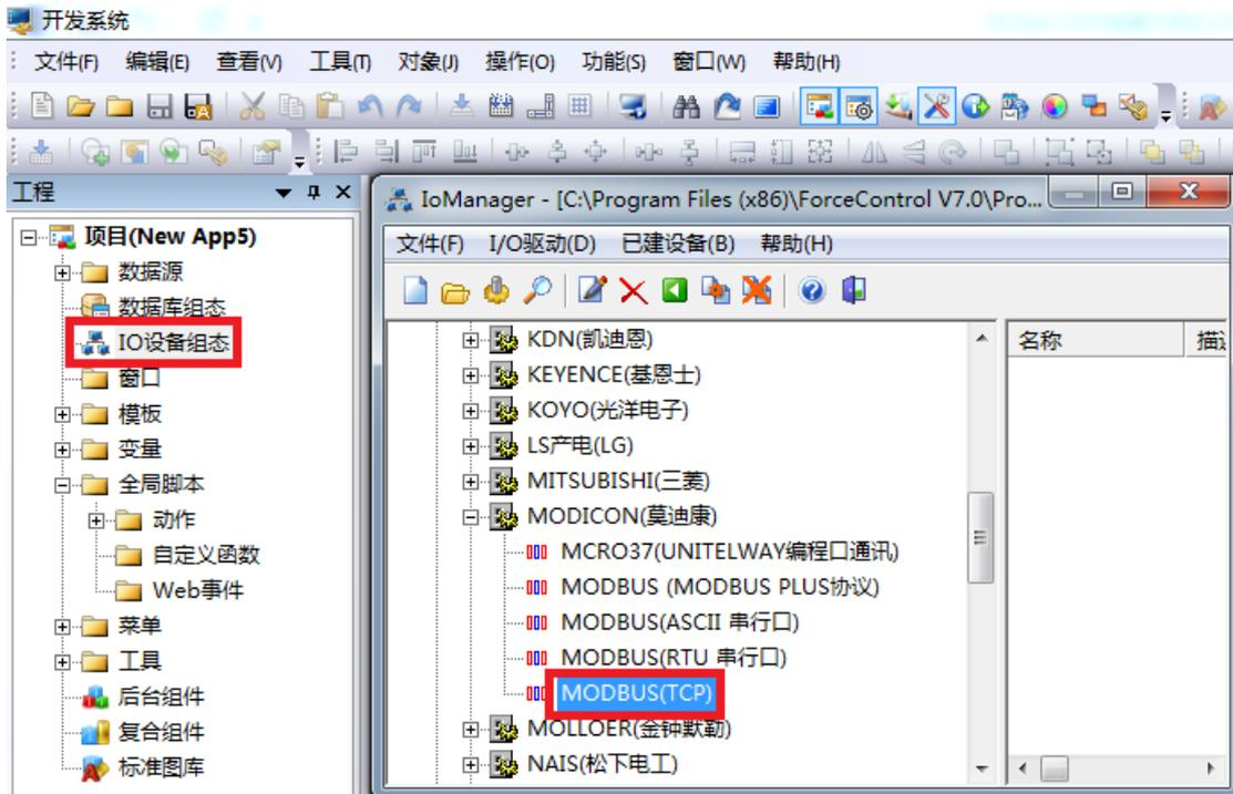
2. 新建一个设备，输入“设备名称”，例如：DVP，输入“设备地址”，默认为 1，这里的【设备地址】请根据实际的 Modbus 设备的地址填写，点击“下一步”。
