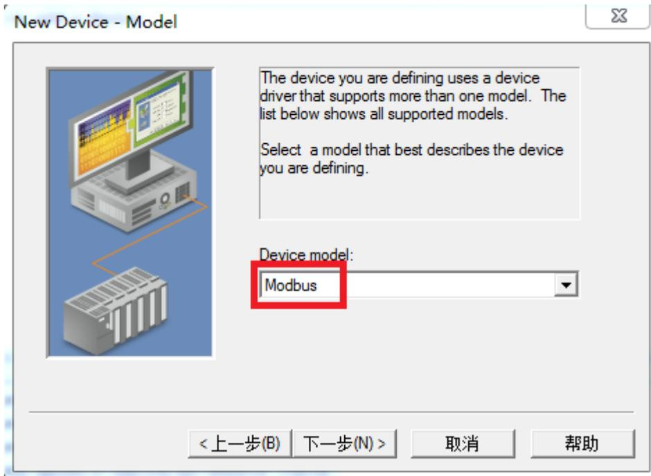
6.“Device ID”处输入模块的 IP 地址.设备地址，默认为：192.168.1.178.0，这里的【设备地址】请根据实际的 Modbus 设备的地址填写，点击下一步，其它参数默认。.
