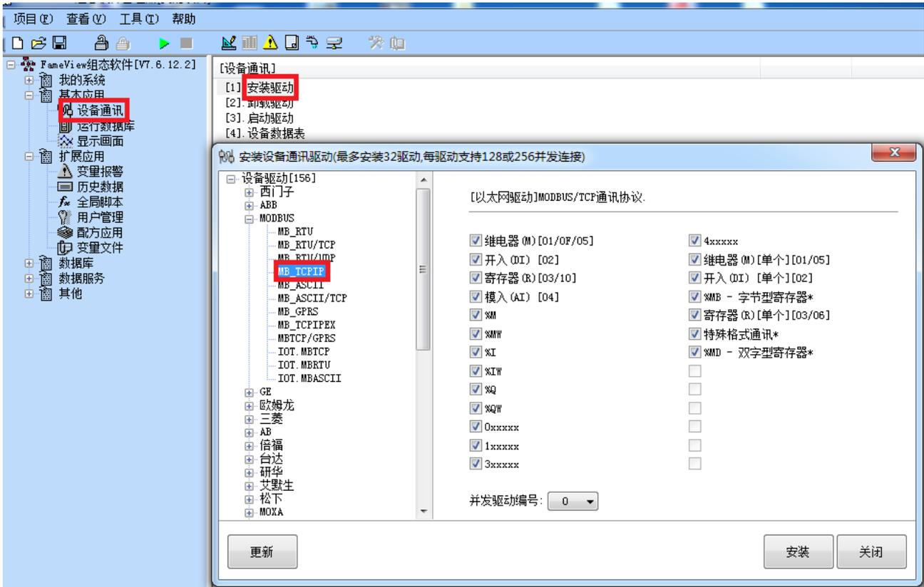
2. 双击“设备数据表”，输入“设备号名称”，例如：XJ，输入“MB 端口号”，这里的【MB 端口号】请根据实际的 Modbus 设备的地址填写，输入“端口号”，默认为 502，输入“设备 IP 地址”为 QSK NET-MB 的 IP 地址，例如：192.168.1.178，点击“确认”。
