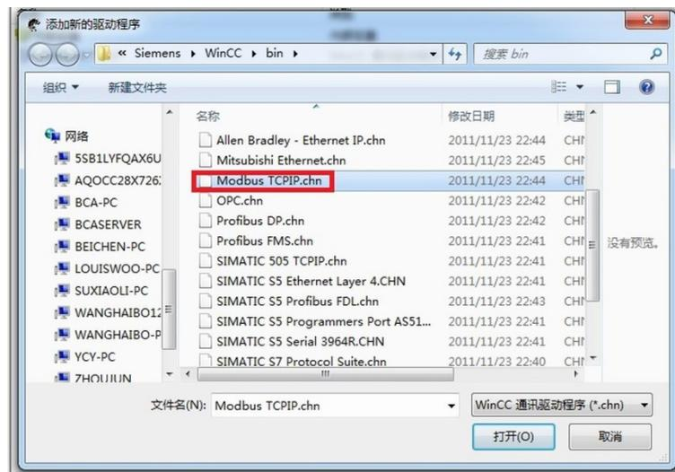
2. 右击“Modbus TCP/IP 单元#1”选择“新驱动程序连接”，新建一个名称，点击“属性”，弹出属性的对话框，在“CPU 类型”选择“984”，在“服务器”中填入 QSK NET-MB 的 IP 地址，“端口”默认为 502，“远程从站的地址”处填入 Modbus 设备地址，点击确定。
